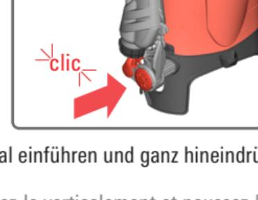
Pumpehebel herausziehen, vertikal einführen und ganz hineindrücken
